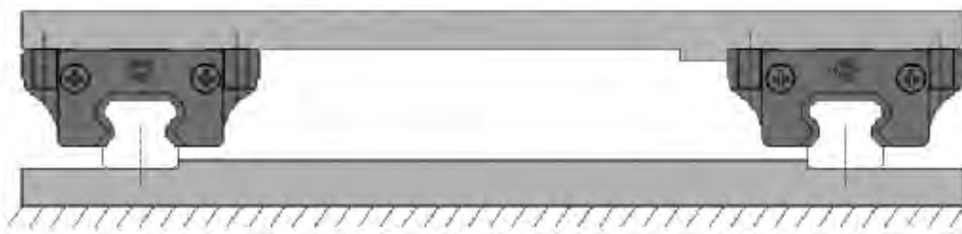
(A) Su piano orizzontale con pattini traslanti (A) Horizontal plane with free blocks
