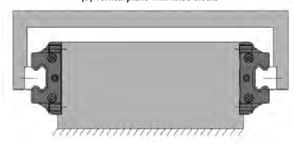
(D) Su piano verticale con pattini fissati (D) Vertical plane with fixed blocks
